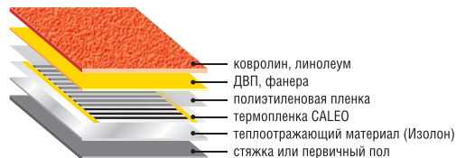
Рис. 3. Схема монтажа теплого пола CALEO под ковровин или линолеум
