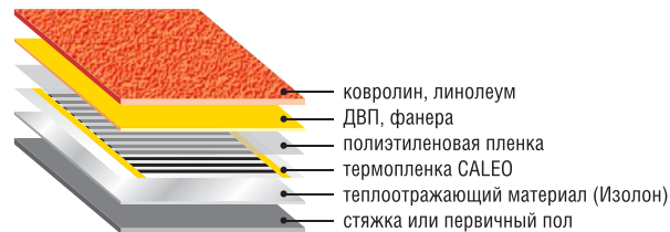
Рис. 28. Схема монтажа теплого пола CALEO под ковролин или линолеум
