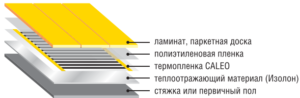
Рис. 27. Схема монтажа теплого пола CALEO под ламинат или паркетную доску
